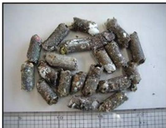
図 5-30 プラスチックゴミからリサイクルされた補助燃料(RPF)
