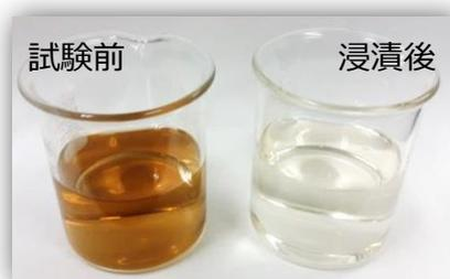
図1 ハイドロガーネットを用いた水質浄化評価
