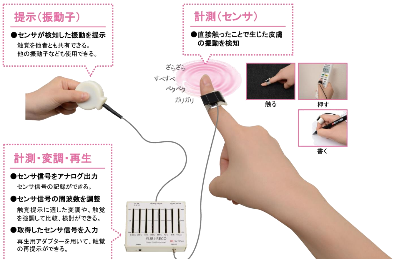
図1 触覚記録装置(ユビレコ)の仕組み
