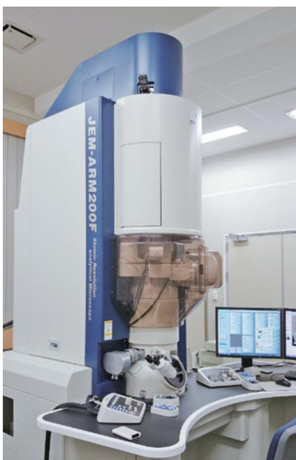
原子レベルで元素分析が可能な走査透過電子顕微鏡
