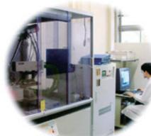
高感度超強力X線結晶構造解析装置
