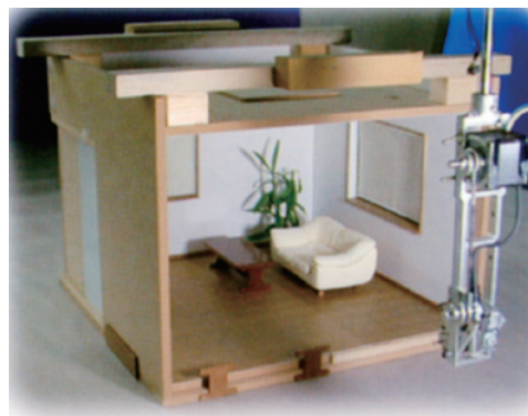
建築空間疑似体験のための模型立体視 VTRシステム
