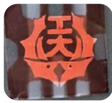
シーソー型太陽電池
