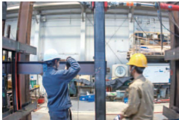
鋼構造骨組の部分架構実験
