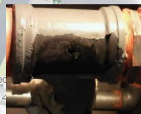
汚水管腐食による漏水
