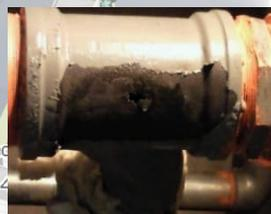
汚水管腐食による漏水
