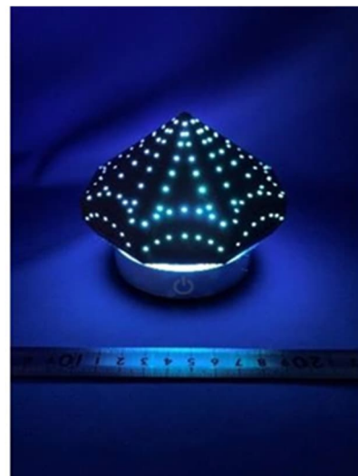
図3 有機蛍光染料を混合した無焼成セラミックス(左)、樹脂製光ファイバーを無焼成セラミックスに包埋したオブジェ(右)
