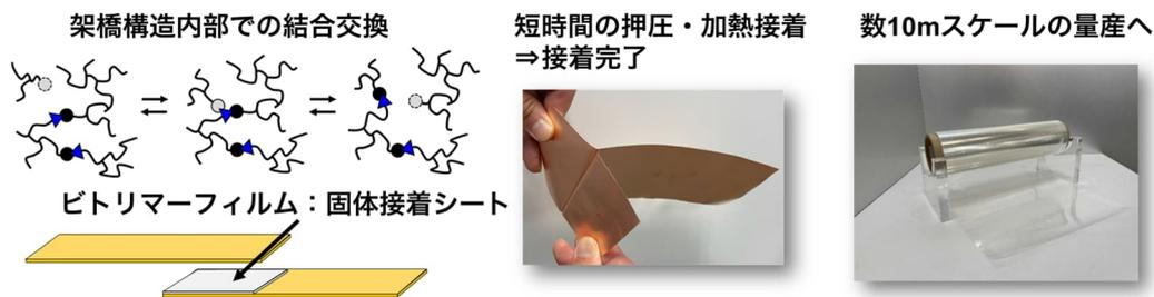
図1. ビトリマーの結合交換を利用した固体接着シート
