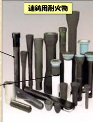
浸入ノズルの構造部分毎に数種の材質が張り分けされている
